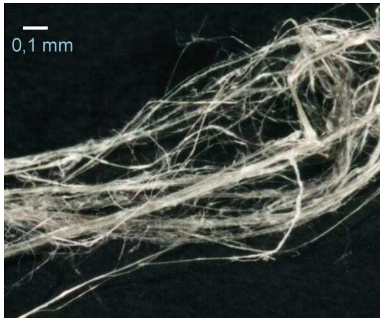
Fot. 1. Długowłóknisty azbest chryzotylowy praktycznie nie zawierający zanieczyszczeń (Chiny)
