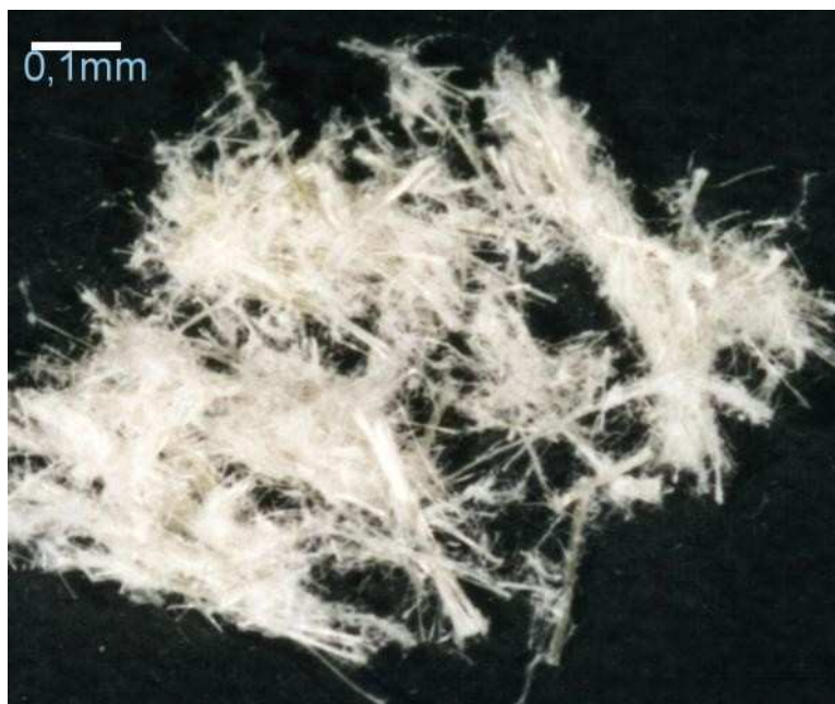
Fot. 2. Chryzotylowy azbest krótkowłóknisty zanieczyszczony talkiem
