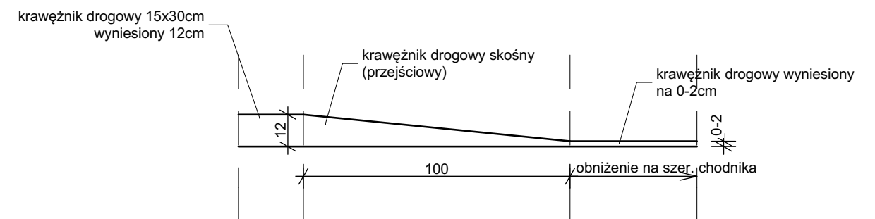
SZCZEGÓŁ OBNIŻENIA KRAWĘŻNIKA NA ZJAZDACH 1:20
